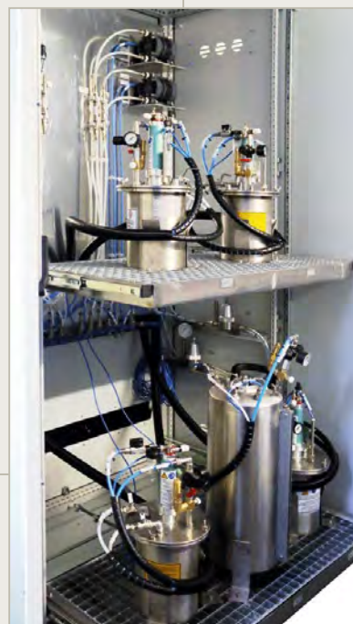
Farbversorgungsschrank mit 4 Farb- und 1 Spülmitteldruckbehälter
