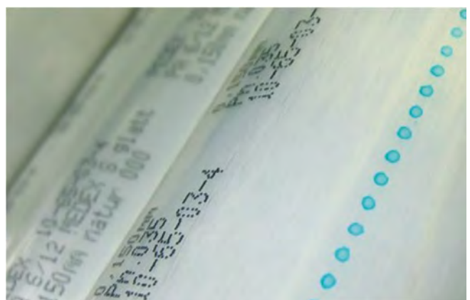
Kontrolllinie auf PE-Folienschlauch
