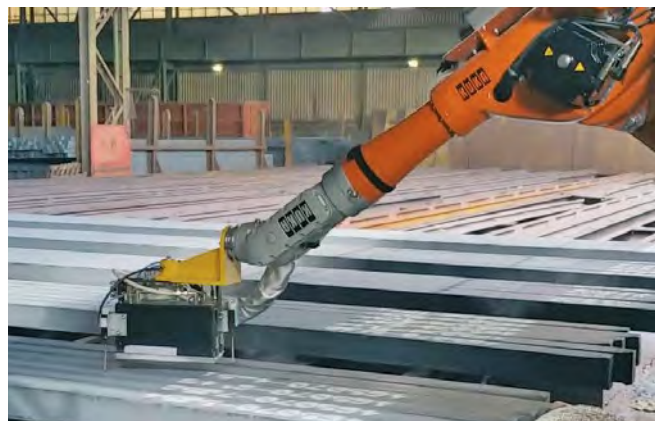
Knüppelmarkierung mit Heißsignierfarbe an Roboter
