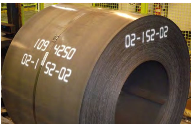
Beschriftung auf Stahlcoils
