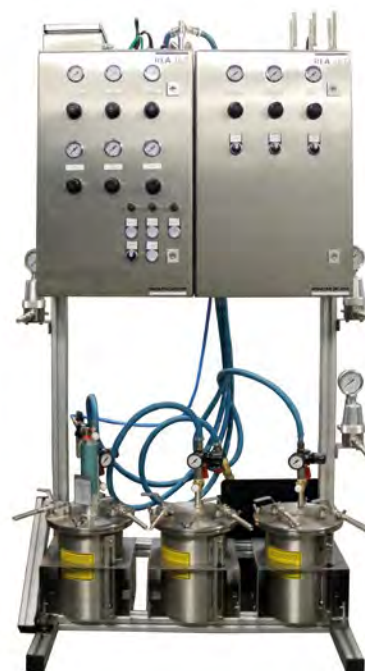
Flexibles Komplettssystem STF für bis zu 4 Signierköpfen und Farben
