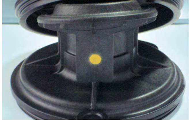
Gutteilmarkierung nach Qualitätsprüfung
