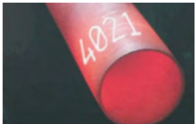
Beschriftung von glühendem Stahl mit Heißsignierfarbe
