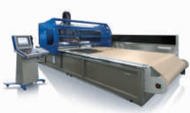
Mitfahrende Haube und Teiletransport durch Papiervorschub
