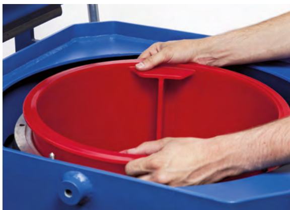
Einfacher Wechsel des Schlammkorbes ohne Werkzeuge
