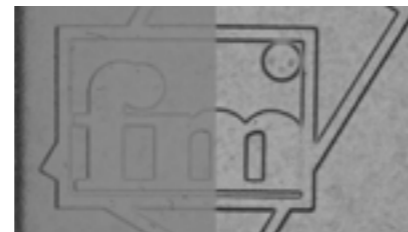
Transparenter Kunststoff mit Prägung – diffuses Durchlicht kollimiertes Durchlicht
