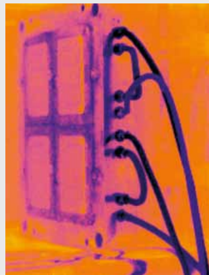
Homogene Temperaturverteilung im Spritzgießwerkzeug nach der Reinigung der Temperierkreisläufe.
