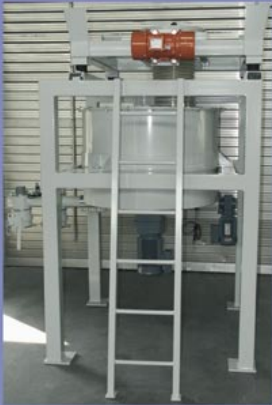
• Container-entleerstation für schwer fließende Schüttgüter mit Vibrationsplattform
