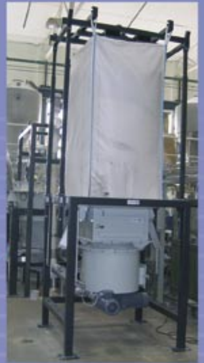
• Dosiererauslauf Typ AFT drückend mit T-Übergabe in den Hochförderer
