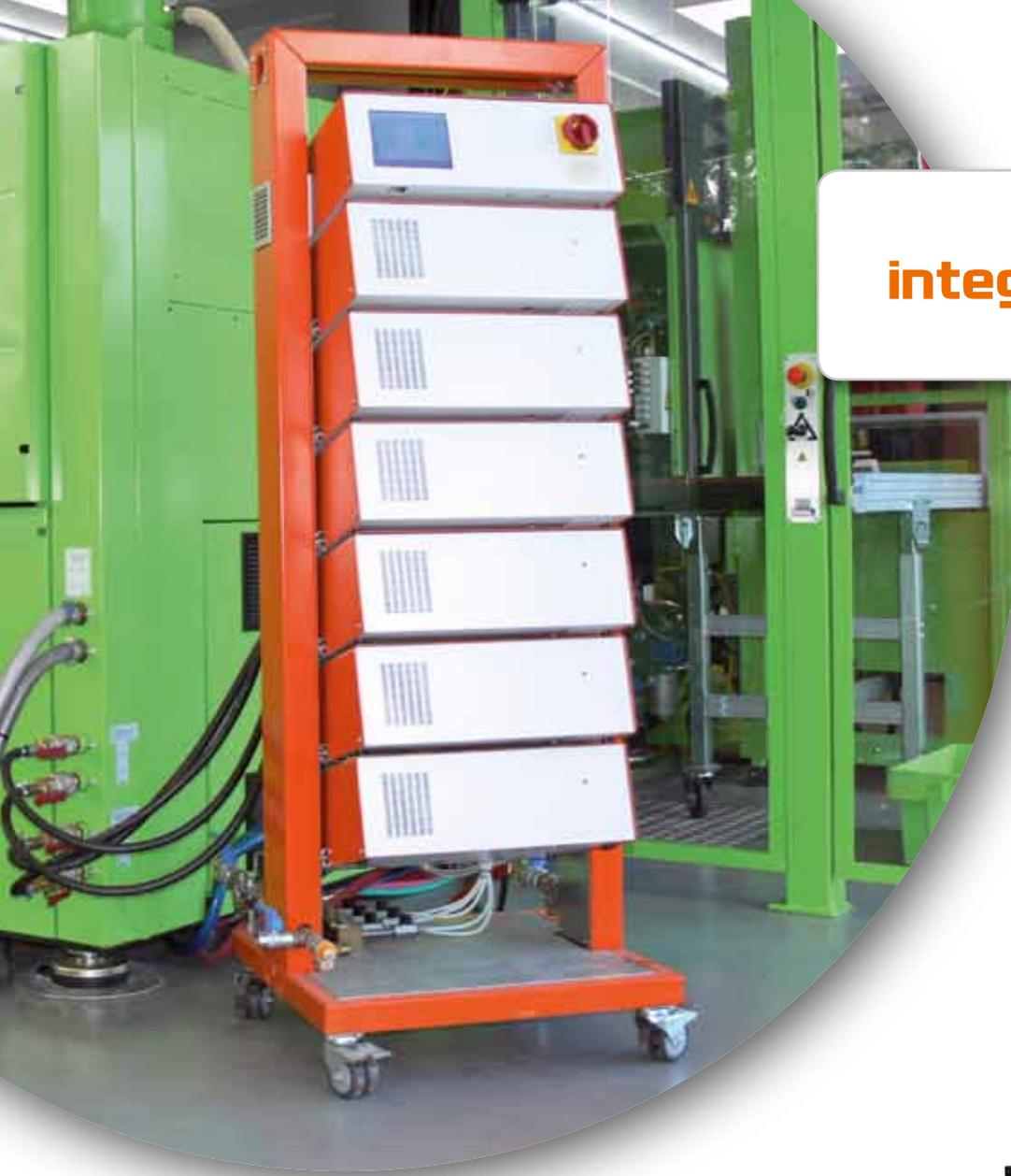
Das **gwk integrat 40** ist ein modular aufgebautes, in den Gesamtprozess integrierbares Mehrkreis-Temperiersystem für die segmentierte Werkzeugtemperierung.
