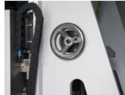
Kurbel zur vertikalen Höheneinstellung des Scanners
