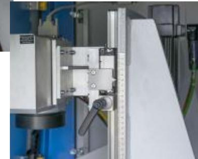
Skala zur vertikalen Höheneinstellung des Scanners
