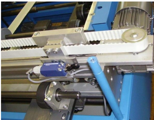
Vollautomatische Schere (Endlage Übereinschalter)
