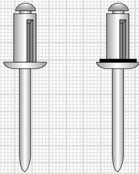
Die großflächige Auffaltung des Schließkopfes von Presslaschen-Blindniete sorgt analog zu dem auf ► [SeiteSeite 76](#) zu sehenden **ARCO®**-Spreizblindniet für eine **gleichmäßige Verteilung der auftretenden Kräfte**, wodurch speziell weiche oder spröde Bauteile weniger stark belastet und die Oberflächen geschont werden. Auch nicht plane Bauteile eignen sich für die Verarbeitung, da sich die Schließkopflaschen an die Konturen anpassen.
