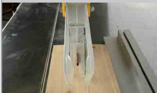
Aluminium-Parallelanschlag mit flacher Anlegekante Bessere Sicht auf den Schnitt durch veränderte Sicherheitsschutzhaube
