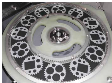
Polierprozess mit Sonderabwälzvorrichtung für filigrane Werkstücke
