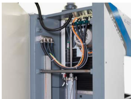
Abklappbarer Schaltschrank für optimale Maschinenzugänglichkeit
