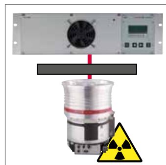
Verbindung zwischen HiPace und TCP 1200
