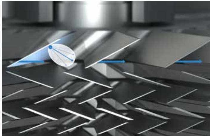
Rotor: Überlagerung mit Schaufelgeschwindigkeit
