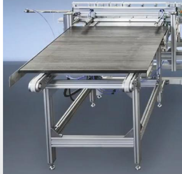
WKF 170 als automatische Kantenfräsanlage mit Vorschubmodul und Rollenbahn
