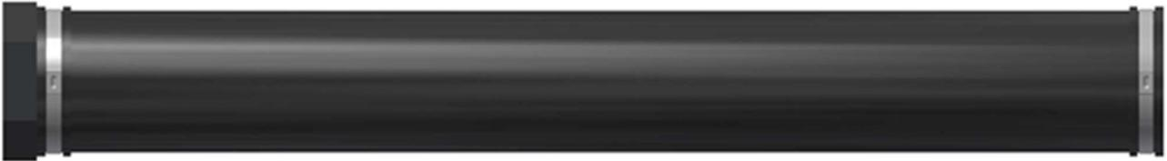
Die präzise Perforation sorgt für hohen Sauerstoffeintrag und geringen Druckverlust. Die Membranbefestigung erfolgt mittels Klemmschellen aus Edelstahl am Stützrohr: Eine spezielle Aufnahme für Edelstahlschellen an den Enden der Membranen erleichtert auch bei einem Austausch der Membranen vor Ort das passgenaue Anbringen der Schellen und steigert die Dichtwirkung.
