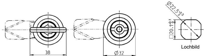
**Gehäuse und Betätigung GD-Zn schwarz gepulvert oder AISI 316, Mutter und Schraube St verzinkt bzw. Edelstahl, mit Feder und Dichtung**
