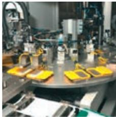
Montageautomat für Gasgeneratoren
