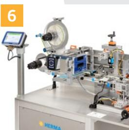
Auf Wunsch stehen für den Rundum-Etikettierer 211 HC viele weitere Optionen, wie zum Beispiel die zu einem Merkmal ausgerichtete Rundum-Etikettierung, die pneumatische Fixierung der Produkte oder die Schlechtetikettenrückführung zur Verfügung.
