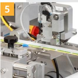
Für die Etikettierung von häufig wechselnden Produkten mit abweichenden Abmessungen können optional Formateile mit Schnellwechseinheit geliefert werden. Das ermöglicht jederzeit einfache Formatwechsel ohne lange Umrüstzeiten.
