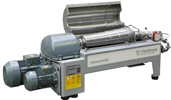
Mobile Versuchsanlage in Ex-Ausführung und mit Inertisierung
