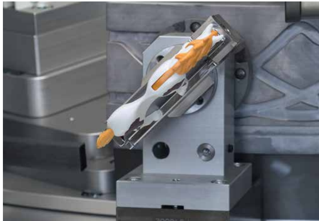
Werkstückaufnahme mit Wendekulisse für beidseitige Bedruckung von Spielzeugteilen
