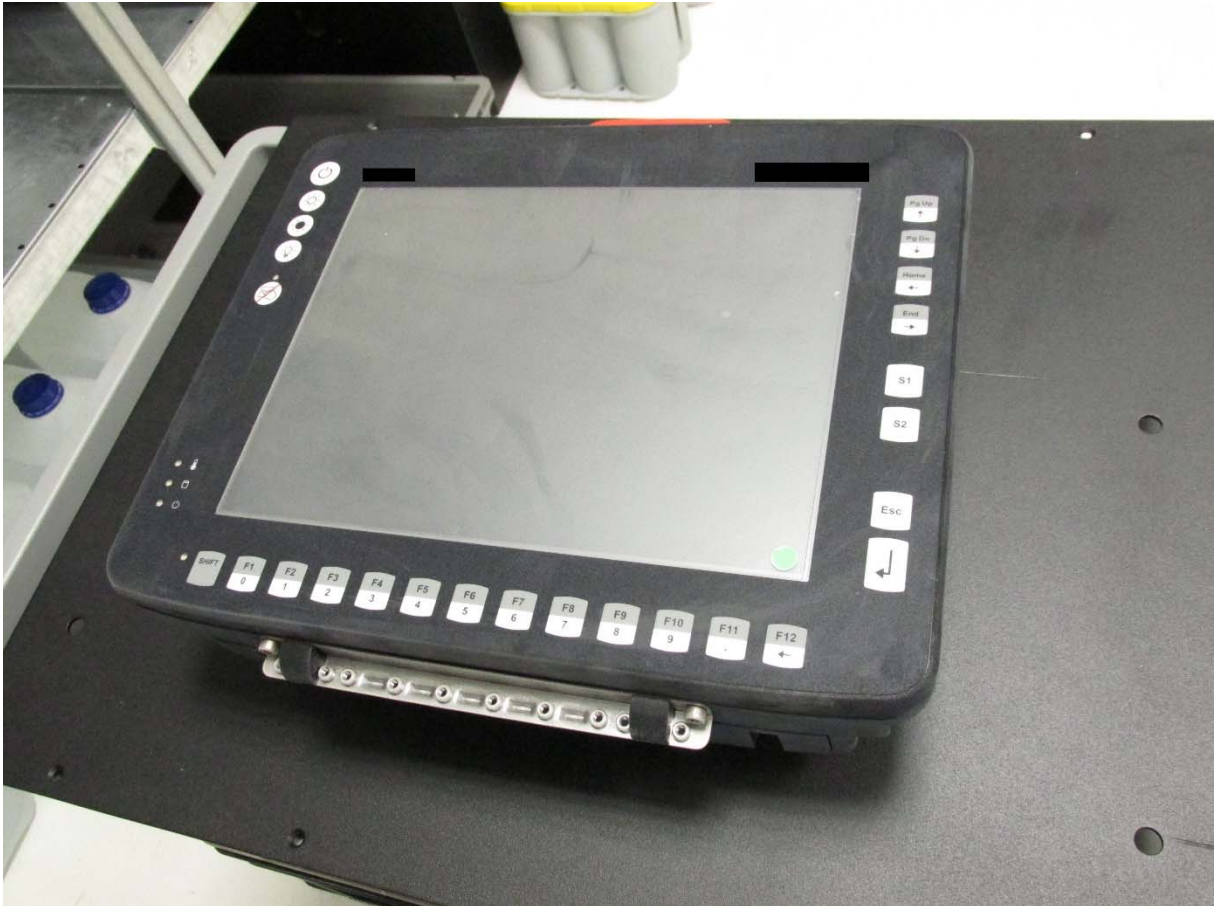
Abbildung 2: Zustand des Panels mit aufgebrachtener Neoxum Spezialfolie nach Abkühlung auf -25 °C
