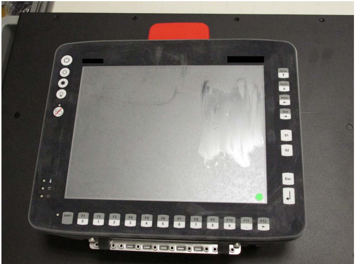
Abbildung 3: Zustand des Panels mit aufgebrachtener Neoxum Spezialfolie nach Abkühlung auf -25 °C und ca. 60 Sekunden bei Raumtemperatur
