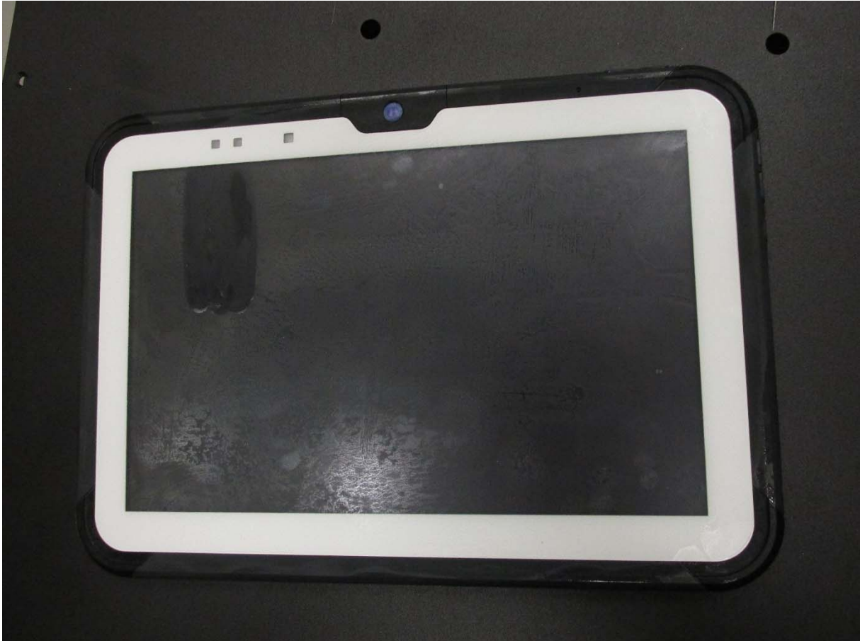
Abbildung 4: Fotodokumentation der hervorragenden Anti-Beschlagwirkung der Neoxum Spezialfolie getestet auf einem ruggedized Casio V-T500 Tablet bei -25 °C
