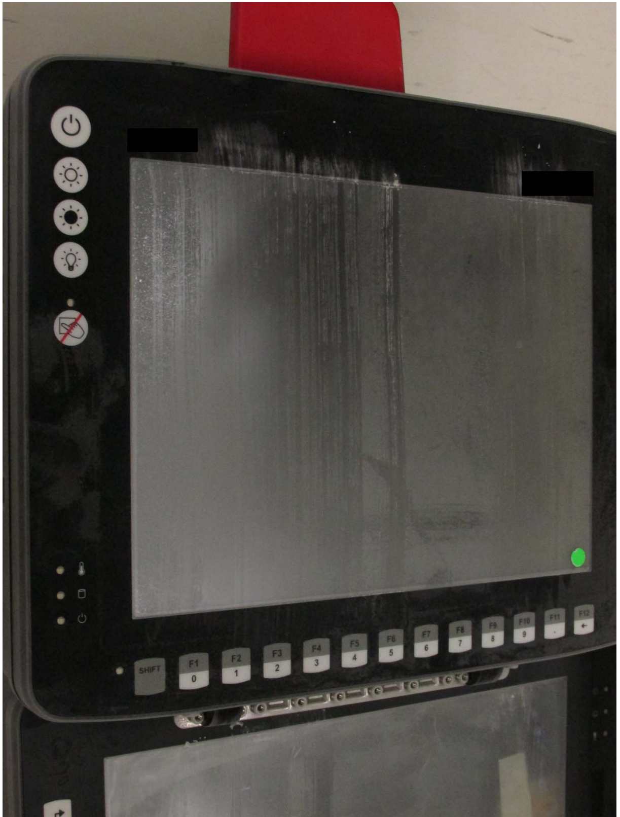
Abbildung 9: Oberfläche mit Neoxum Schutzfolie bei -35 °C und unmittelbarem Abwischen der Reifschicht
