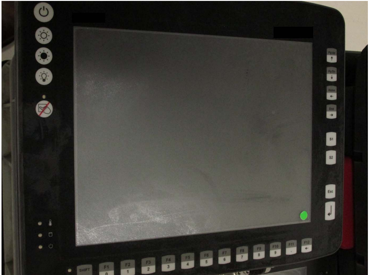
Abbildung 8: Industriepanel bei -35 °C nach Abkühlung von +80 °C auf -35 °C
