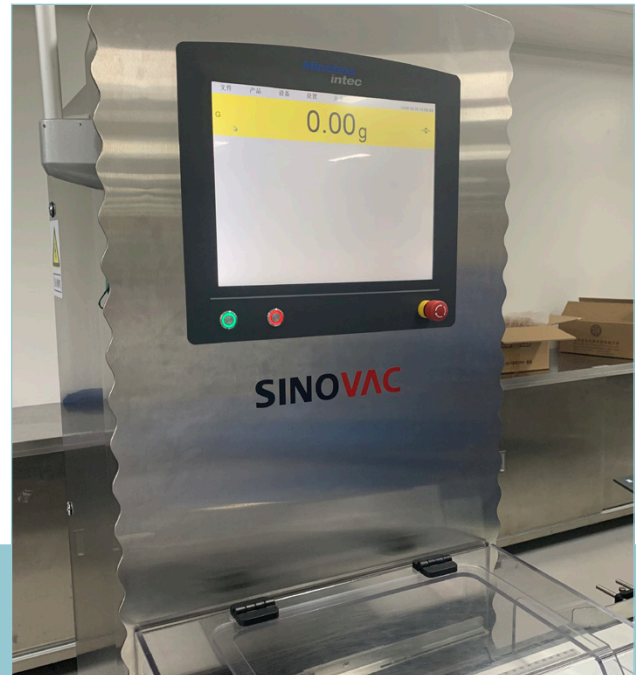
Die Kontrollwaage Synus stellt für Sinovac die sichere Ausschleusung unvollständiger Produkte sicher. Der Durchsatz pro Minute beträgt bis zu 260 Stück
