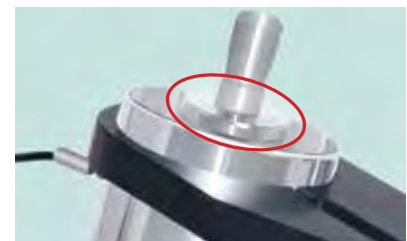
Kontaktfläche des Kraftsensors, über die die Kraft übertragen wird
