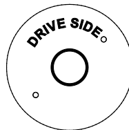
Abbildung 2: Antriebsseite Drehmomentsensor Typ 8656
