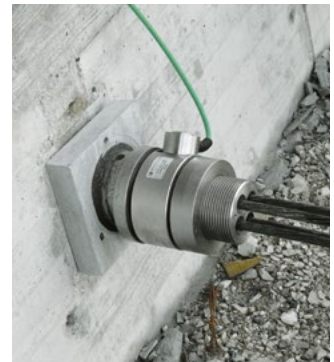
Bild 2: HRL 4 (4 Litzen) montiert auf Litzenanker
