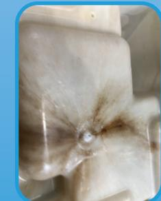
**Über Einwirkzeiten oder Abschaltungen können mit PRIME PURGE X-10 auch Verbrennungen aus Heißkanälen entfernt werden.**
