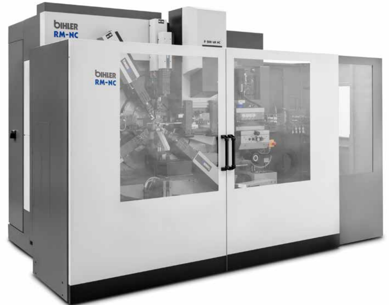
Servo-Stanzbiegeautomat mit integriertem Personenschutz
