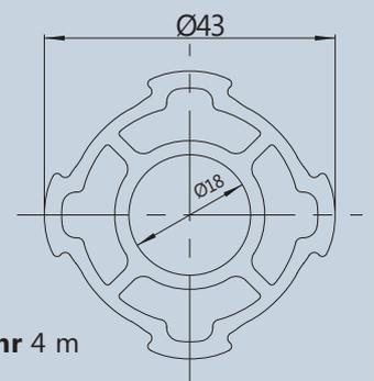
**Schwerlast Aluminium Rohr 4 m**
