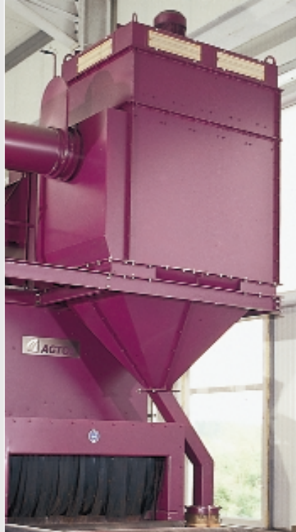
Patronenfilteranlage integriert in eine Rollbahn-Strahlanlage
