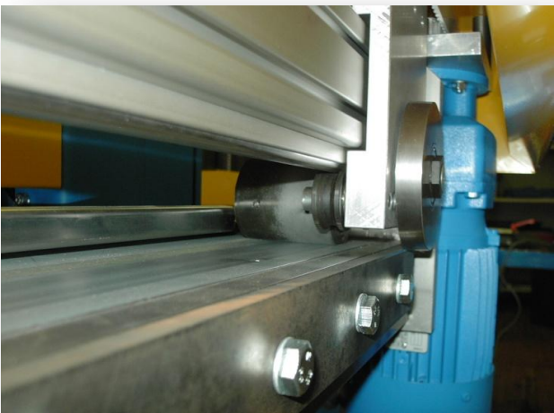
Ansicht Schneidschlitten mit Ober und Untermesser
