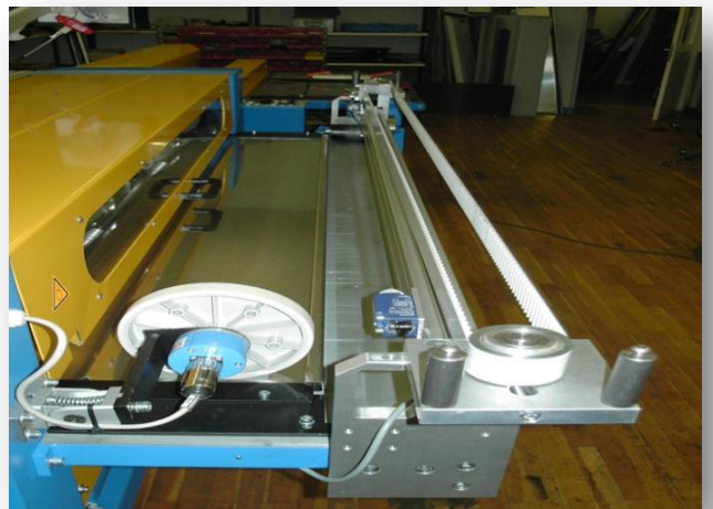
„Schlupffreier“ Antrieb über wartungsfreien Zahnriemen
