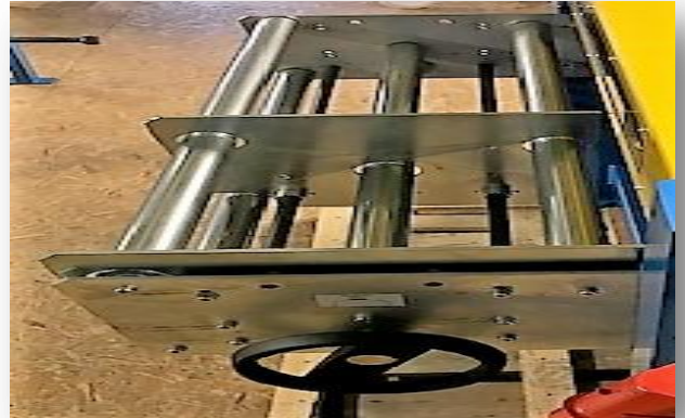
Blecheinlauf der Anlage (mit verstellbarer Führungsbreite)
