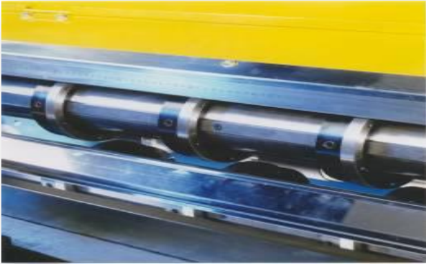
Messerwellen und Messer (verstellbar)
