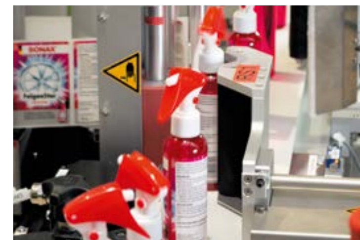
Modell FM-DS – Rundumetikettierung von zylindrischen Produkten
