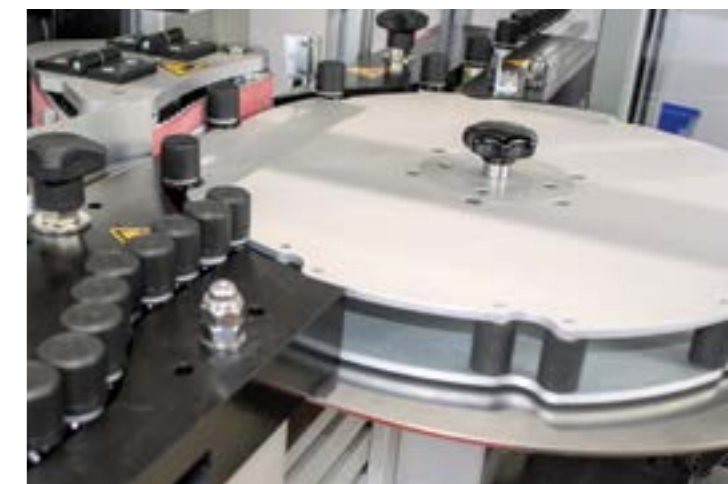
Modell VRM-80RT – Rundumetikettierung mit Rotationsband und Taktstern
