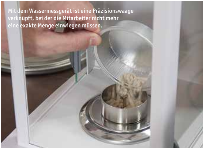
Behutsam setzt der Mitarbeiter das Probengefäß in den Aquatrac. Ein Knopfdruck und nach rund 30 Minuten liegt die Restfeuchte schwarz auf weiß vor.
