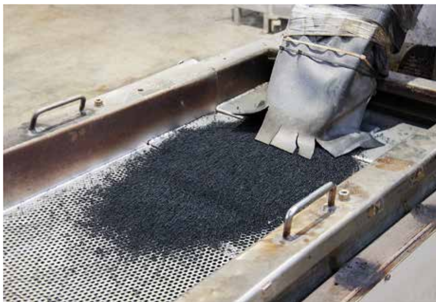
Polyamid Re-Compounds nach der Unterwassergranulierung.
