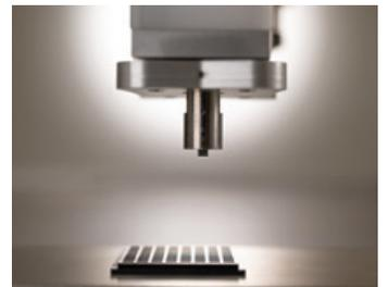
Durch eine Kombination aus Unterdruck und Ultraschall wirken gleichzeitig anziehende und abstoßende Kräfte auf das Werkstück und halten es somit auch beim Greifen von oben auf Abstand. Dadurch können keine Verunreinigungen oder Mikrokratzer auf dem Kleinteil entstehen.
