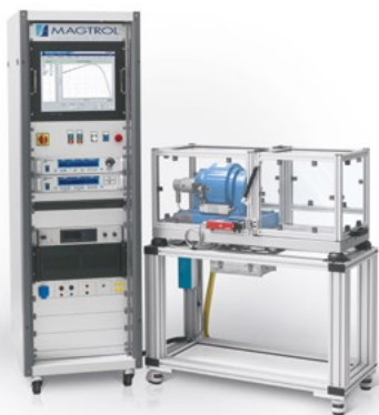
Bild 6: Kundenspezifisches Motorprüfsystem mit WB-Bremse
