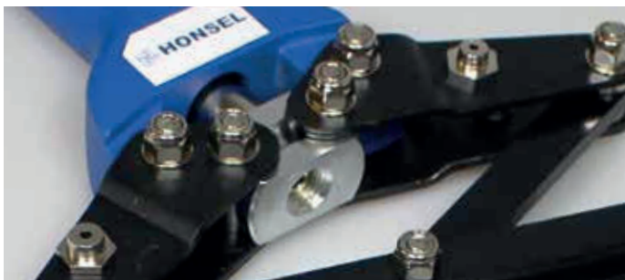
Wechselmündstücke im Werkzeug verschraubt.
