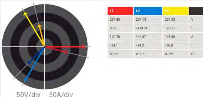
Spannungs- und Stromvektoren sowie Leistungsfaktoren aller Phasen
