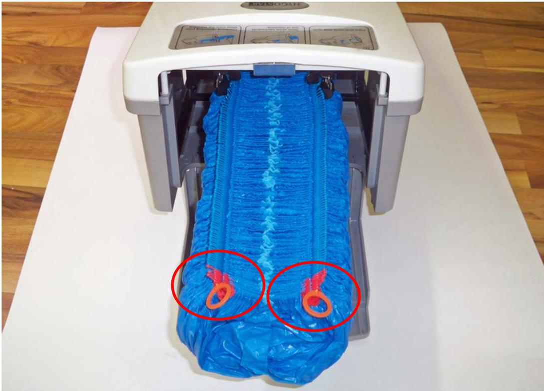
4. Beim Einführen der Überschue müssen die Führungsnoppen ganz korrekt in der Führungsschiene des Überschuhspenders liegen.
