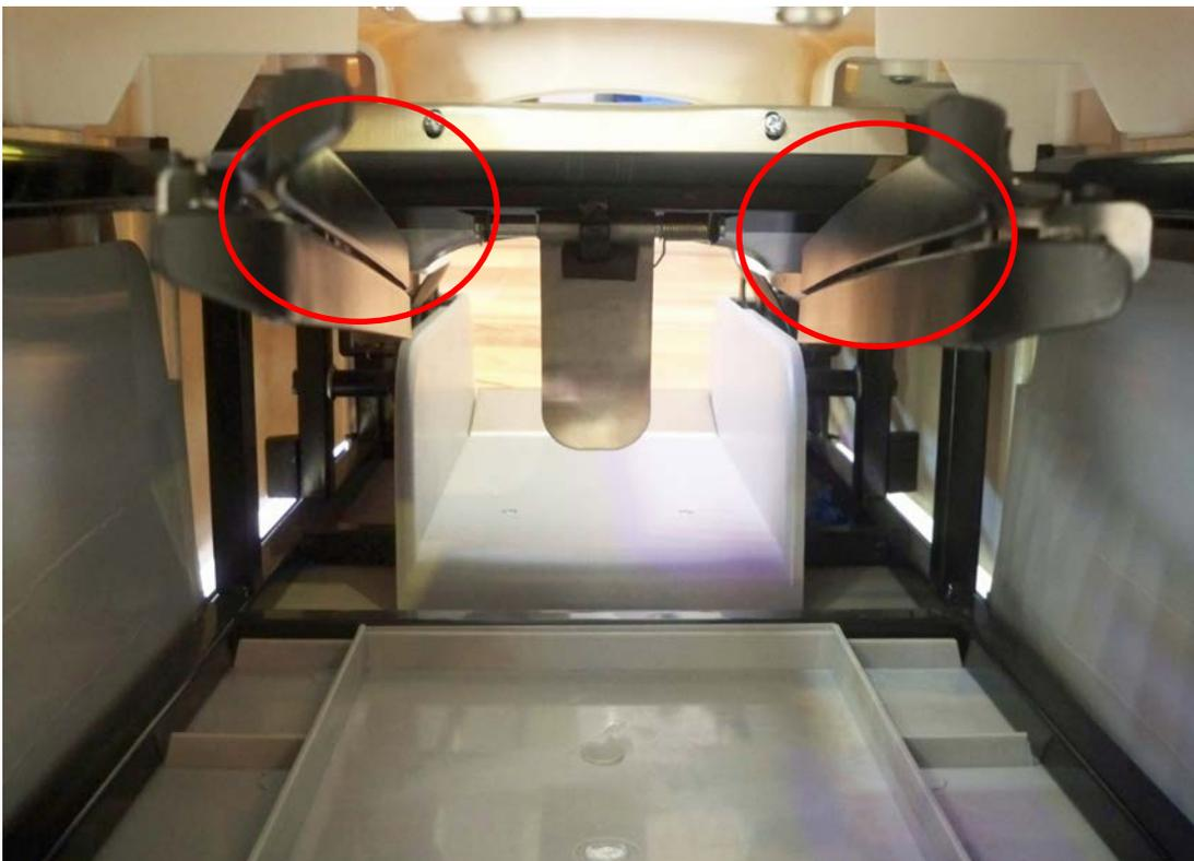
3. Wenn dies sichergestellt ist, können die Überschue in das Gerät eingesetzt werden. Hier muss darauf geachtet werden, dass die roten Führungsnoppen nach hinten zeigen (dienen als Bestandsanzeige).
