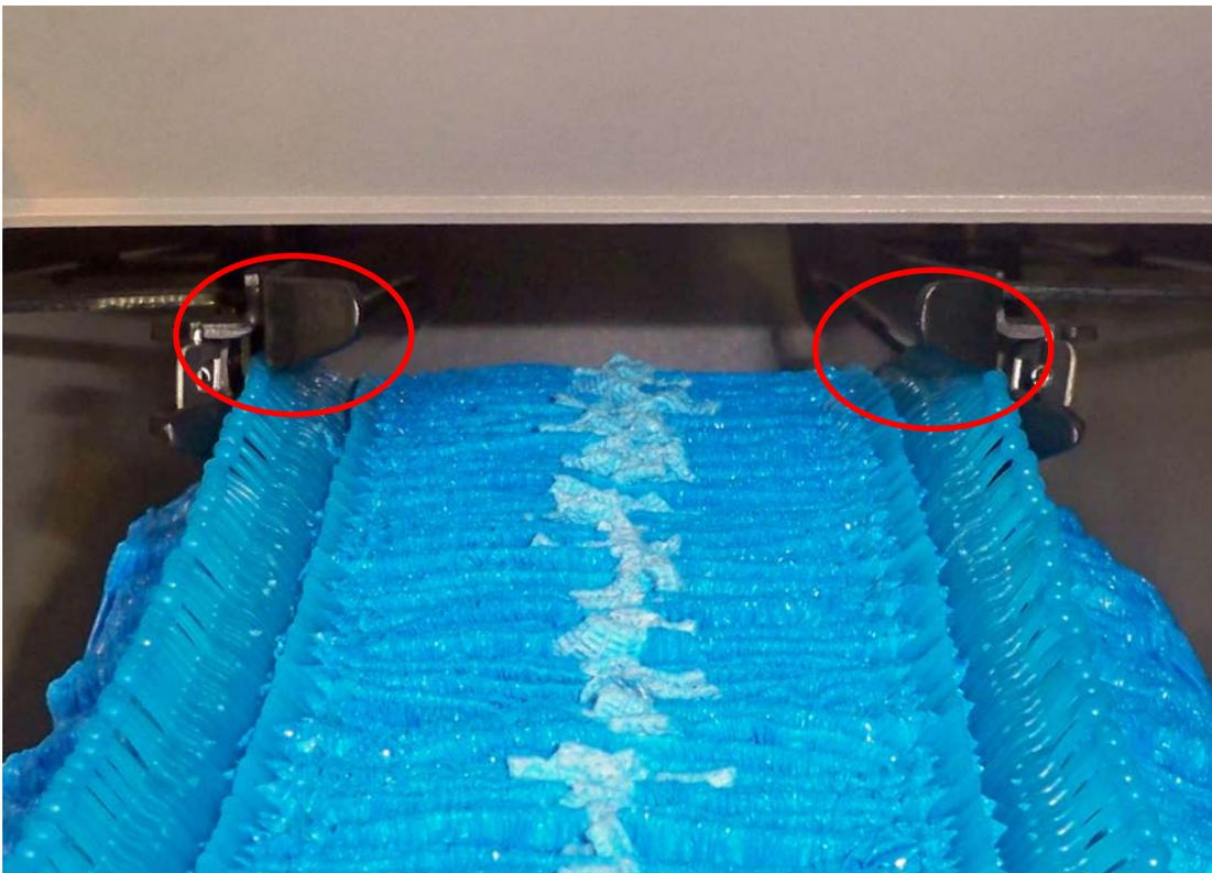
5. Die Überschuhe müssen auf der Vorderseite bis zum Anschlag durchgeschoben werden.
