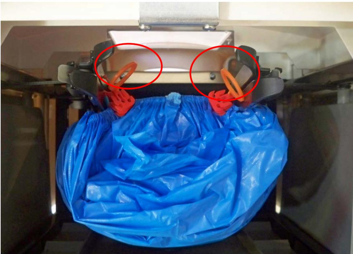
7. Anschließend muss der erste Überschuh manuell gespannt werden. Er muss so weit nach vorne gezogen werden bis der Fuß bequem in die Öffnung passt.
