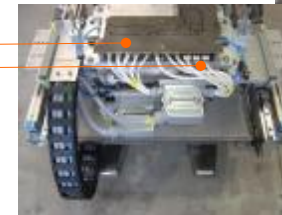
Vibwerkzeug mit integrierter IR-Vorwärmung (Flächenstrahler mit Abdeckmaske)
