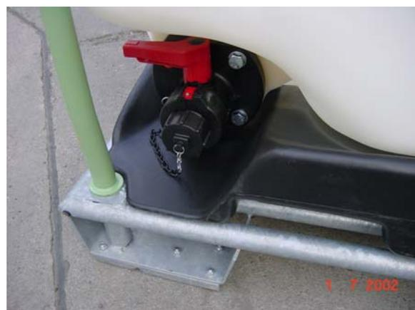
Auslauf : Fast tottraumfreie Kugelarmatur aus PE mit Teflon Kugelsitzen
