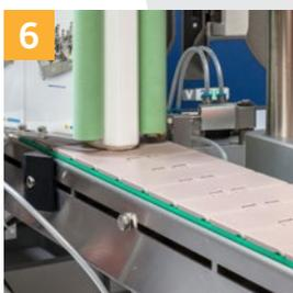
Das Transportband ist mit Gurt oder Platten verfügbar in den Längen 2.160, 2.660 oder 3.160 mm.
